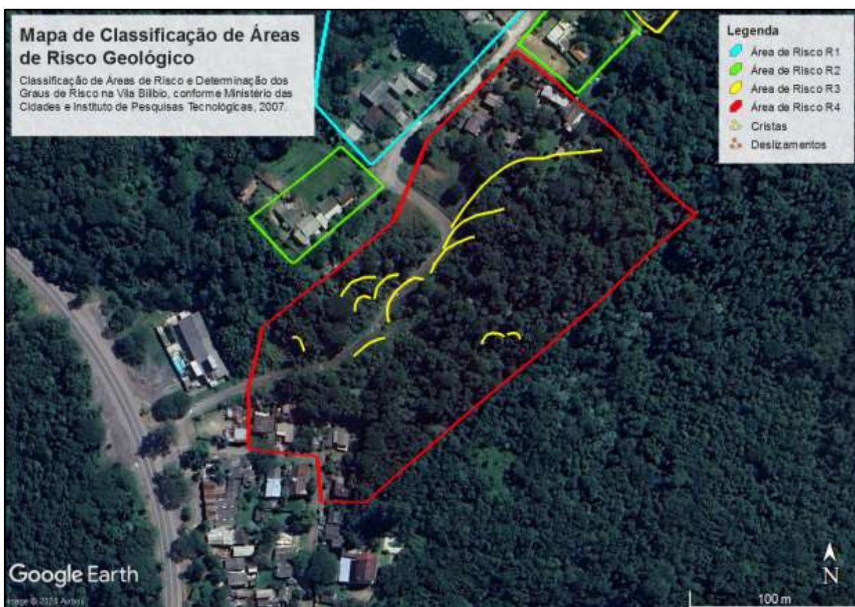
Figura 4: Mapa de Classificação de Áreas de Risco Geológico da Vila Bilibio, representando detalhe das áreas de risco da área inferior da Bilibio e da estrada de acesso para a região superior. Neste mapa estão representadas localmente as principais trincas e cristas de deslizamentos ocorridos no local.
