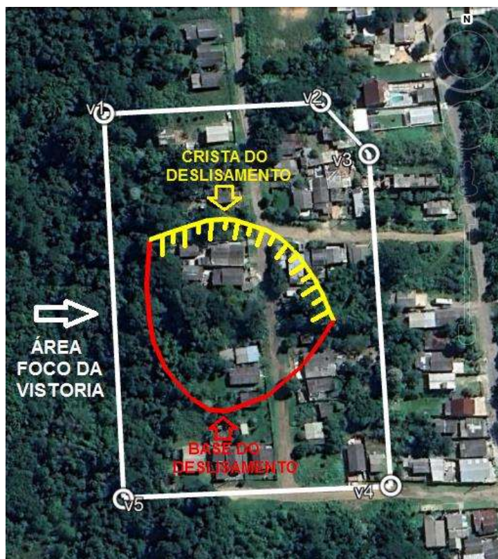
Figura 1- Delimitação da área da vistoria e configuração do deslizamento.
