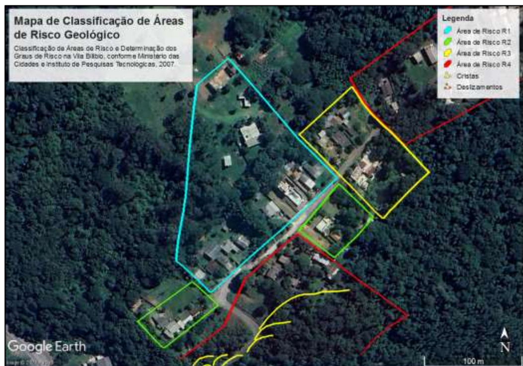
Figura 3: Mapa de Classificação de Áreas de Risco Geológico da Vila Bilíbio, representando detalhe das áreas de risco da área central.
