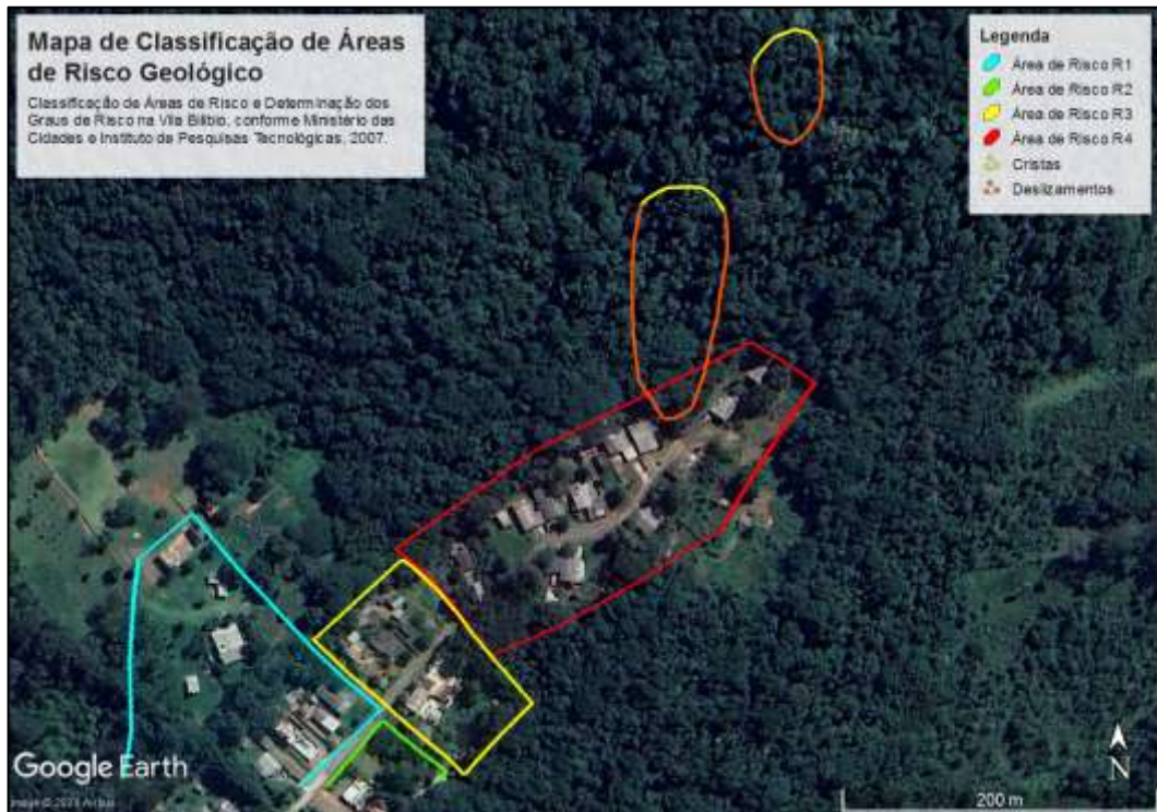
Figura 2: Mapa de Classificação de Áreas de Risco Geológico da Vila Bilíbio, representando detalhe da área de risco R4 da área superior da Vila Bilíbio. Acima do polígono vermelho, que representa a área de risco R4, estão representados as cristas e os deslizamentos mapeados na encosta à montante da área classificada como R4.
