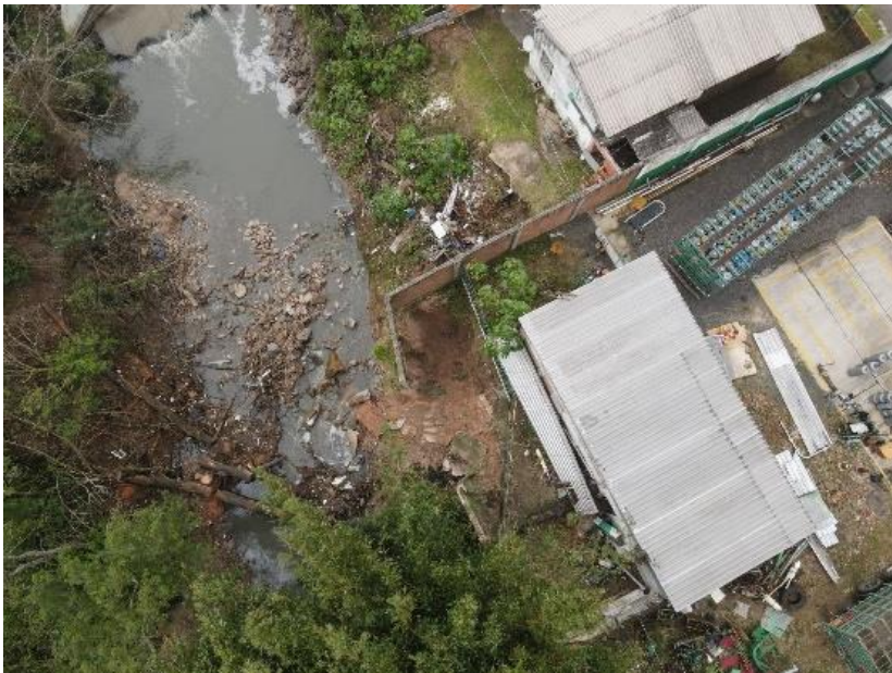
Figura 28. Erosão de margem com solapamento e destruição de muro, terceira moradia de montante a jusante.
