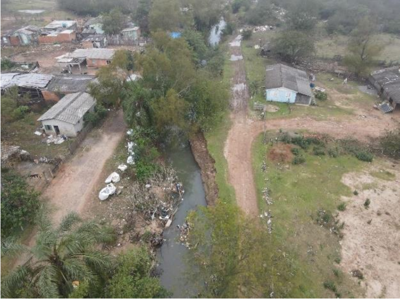
Figura 68. Vista parcial do Setor 13. Vista de cima de bueiro obstruído por lixo, galhos de árvores e entulho.
