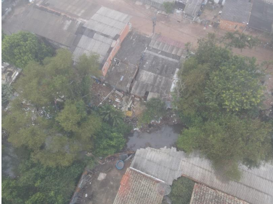
Figura 41. Processo erosivo ativo na margem de aterro, primeira moradia do setor de montante para jusante.
