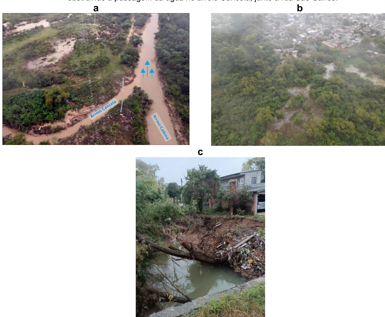
Figura 20. (a) Confluência do arroio Cancela com o arroio Cadena, as setas em azul representam o sentido do fluxo; (b) Antigo canal do Cancela e área de antigos barreiros; (c) Árvore caída (salseiro) em frente a ponte obstruindo a passagem da água no arroio Cancela, junto a rua São Carlos.
