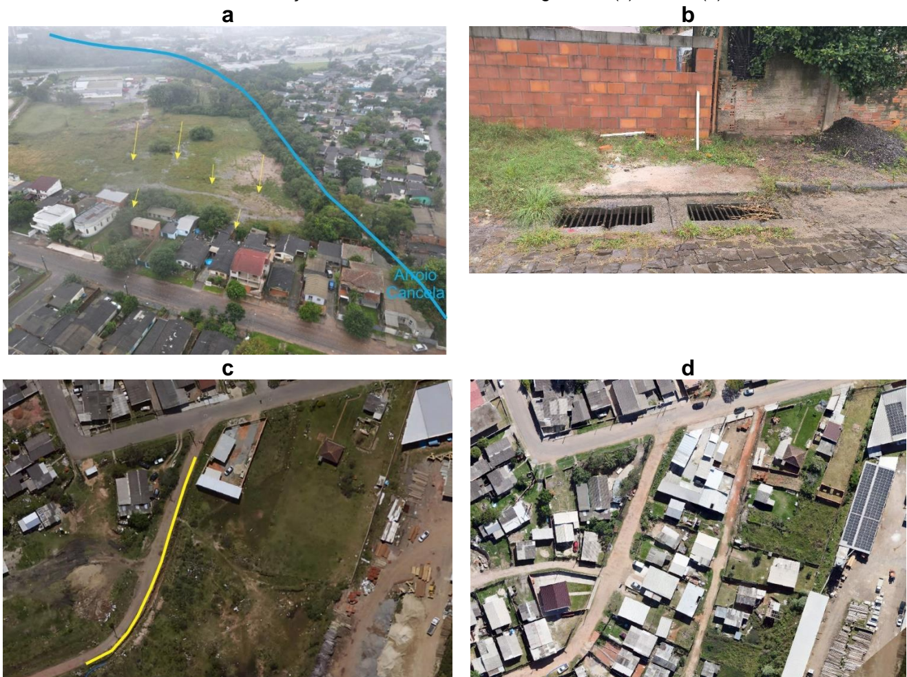
Figura 19. (a) Área de extravasamento do arroio Cancela; (b) Área de bueiros por onde drena o arroio canalizado; Situação do canal artificial de drenagem em (c) 2019 e (d) 2024.
