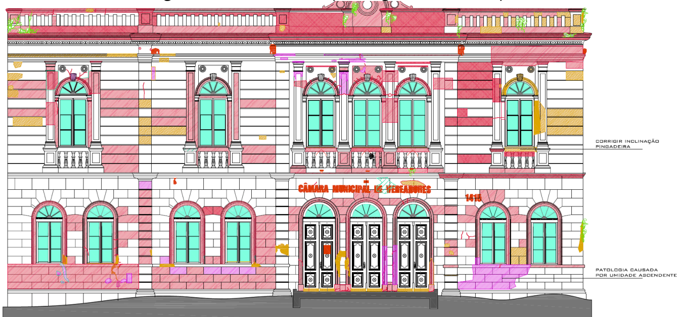
Figura 12: Levantamento de pPatologias Fachada Principal.
