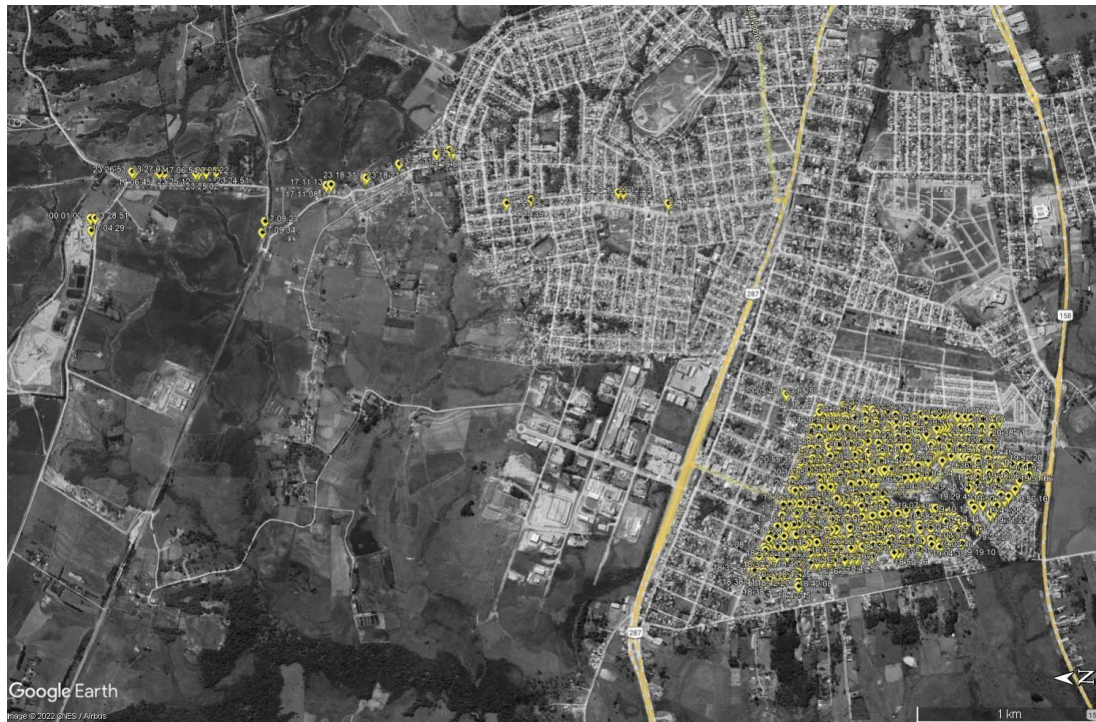
Imagem 5 - Exemplo de arquivo ".kml" gerado com os pontos de parada do caminhão na rota analisada.
